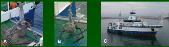
Fig. 1. Muestreadores utilizados durante la campaña INDEMARES 0410 (Megabox corer: A; Mesobox corer: B; B/O Vizconde de Eza (SGMar): C)
